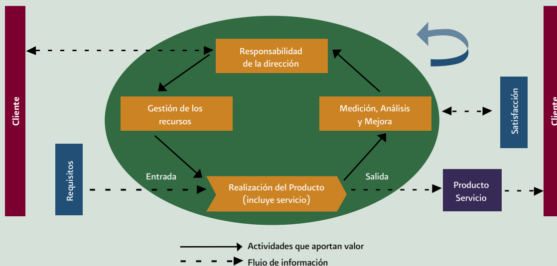
FIGURA A.1.3 EL SISTEMA DE GESTIÓN DE LA CALIDAD: ENFOQUE A PROCESOS Y MEJORAMIENTO CONTINUO
